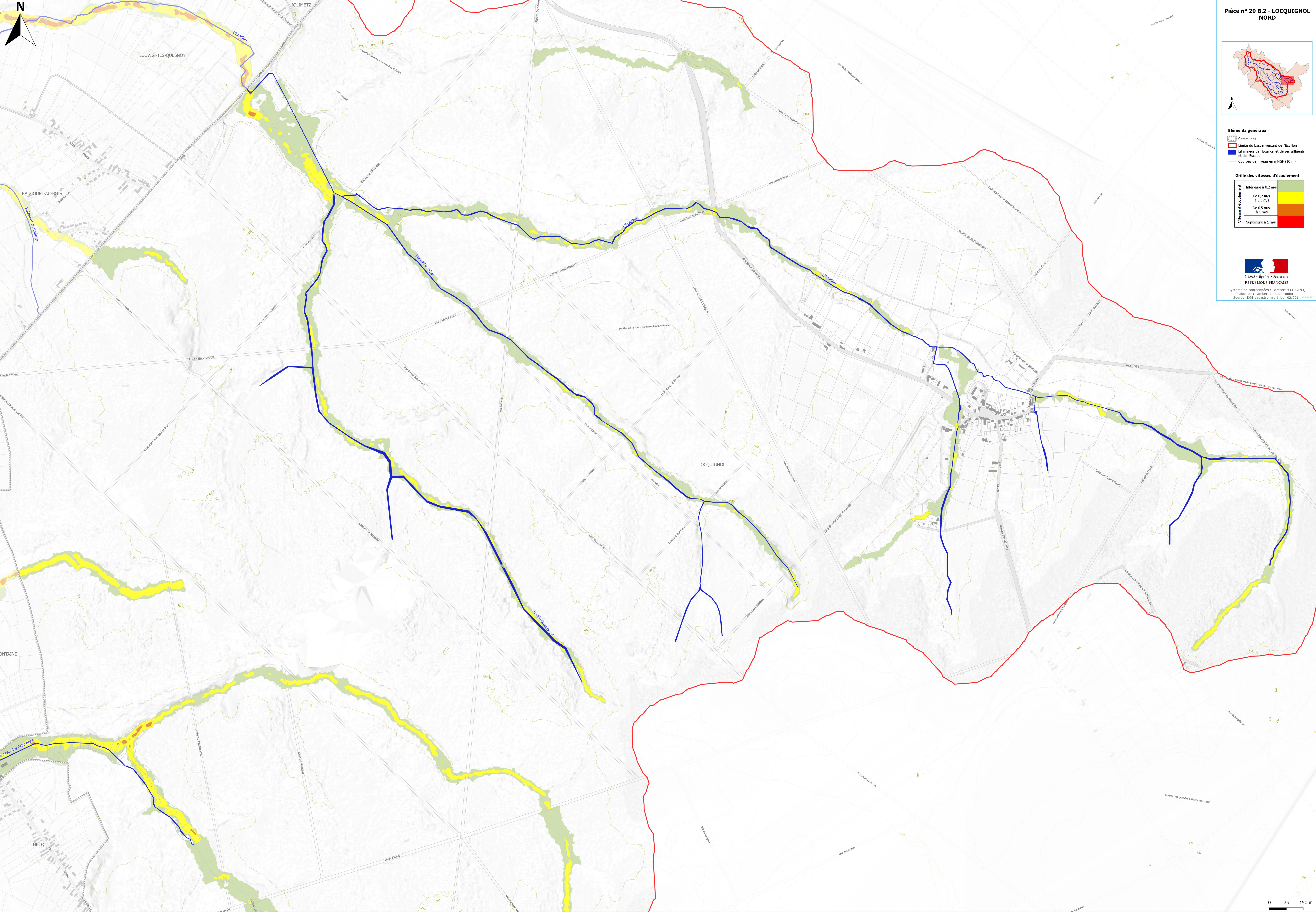
Carte des vitesses maximales d'écoulement de la vallée de l'Ecaillon et de ses affluents
